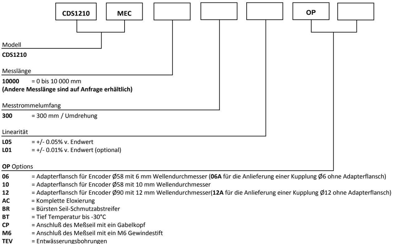
Falls keine Option für den Adapterflansch angegeben wird, wird der Seilzugsensor mit einer Kupplung Ø10 und ohne Adapterflansch geliefert. Weitere Encoder können auf Anfrage angepasst werden, bitte uns kontaktieren.
