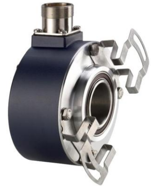
CHU9_25 Anschluss CPR (Stecker M23, radial), mit Reduzierhülse 9418/I25 (25mm) montiert
