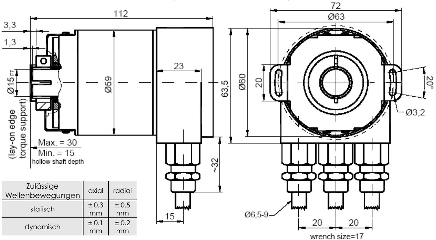
Der Wellendurchmesser kann auf 12mm, 10mm oder 8mm durch einen Reduzerring verringert werden(wird in die Hohlwelle eingesteckt).
