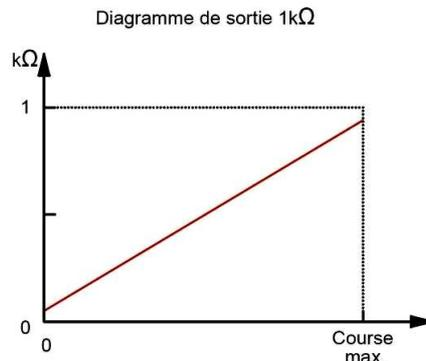
Pour garantir une bonne linéarité il faut câbler le potentiomètre en diviseur de tension et jamais en rhéostat. La résistance d'entrée du système d'exploitation doit être très élevée (supérieur à 10MΩ)
