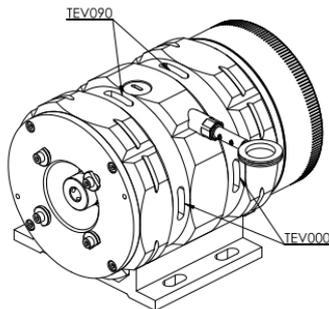
Préciser l'angle d'implantation des trous d'évacuation suivant le plan ci-dessous (Toute valeur comprise entre 0 et 360°)
