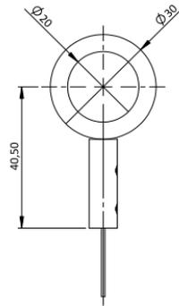
**Accroche du câble de mesure par une tige filetée M6 :**
