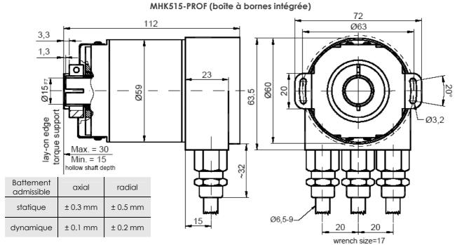
Le diamètre de l'axe creux peut être réduit à 12mm, 10mm ou 8mm en utilisant des bagues (en les glissant dans l'axe creux)
